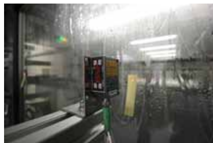
Pohľad na veľkú klíma komoru pre modelovanie synergických javov transferu tepla, difúzie vodnej pary a filtrácie vzduchu
