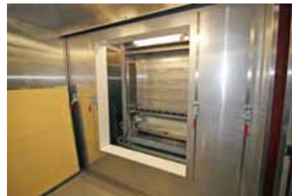
Pohľad na veľkú klíma komoru pre modelovanie synergických javov transferu tepla, difúzie vodnej pary a filtrácie vzduchu
