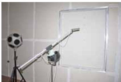
Interiér vysielacej komory akustických komôr s reproduktorovou sústavou Brüel & Kjaer typ 4292-L. V skúšobnom otvore sa meria vzduchová nepriezvučnosť hliníkového okna s vertikálne umiestnenou akustickou vetracou mriežkou.
