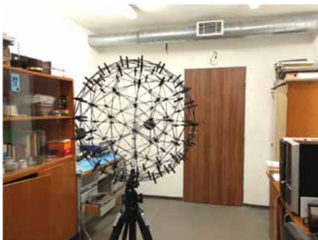
Pohľad na zostavu akustickej kamery gfaí pri meraní v laboratóriu katedry KPS
