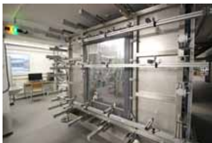
Okno osadené v dažďovej a tlakovej komore
