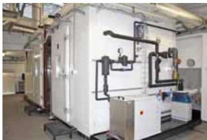
Pohľad na veľkú klíma komoru pre modelovanie synergických javov transferu tepla, difúzie vodnej pary a filtrácie vzduchu
