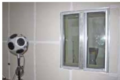
Interiér vysielacej komory akustických komôr s reproduktorovou sústavou Brüel & Kjaer typ 4292-L. V skúšobnom otvore sa meria vzduchová nepriezvučnosť hliníkového okna s vertikálne umiestnenou akustickou vetracou mriežkou.
