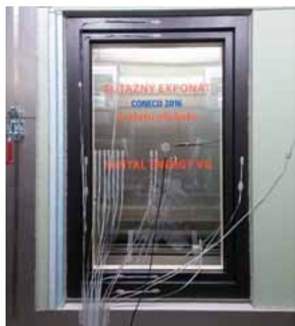
Pohľad na experimentálne meranie tepelnotechnických vlastností okna v klíma komore
