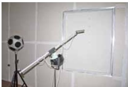
Interiér vysielacej komory akustických komôr s reproduktorovou sústavou Brüel & Kjaer typ 4292-L. V skúšobnom otvore sa meria vzduchová nepriezvučnosť hliníkovej okna s vertikálne umiestnenou akustickou vetracou mriežkou.
