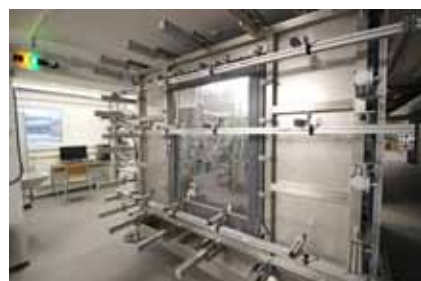
Okno osadené v dažďovej a tlakovej komore
