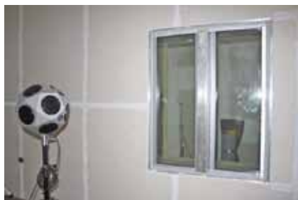
Interiér vysielacej komory akustických komôr s reproduktorovou sústavou Brüel & Kjaer typ 4292-L. V skúšobnom otvore sa meria vzduchová nepriezvučnosť hliníkovej okna s vertikálne umiestnenou akustickou vetracou mriežkou.
