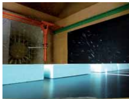
Obr. 10 Optimalizácia urbanistických štruktúr z hľadiska pôsobenia vetra, vizualizácia vzduchového prúdu: a) pomocou dymu, b) héliovými bublinami (autor: Ing. arch. Martin Hépal)
