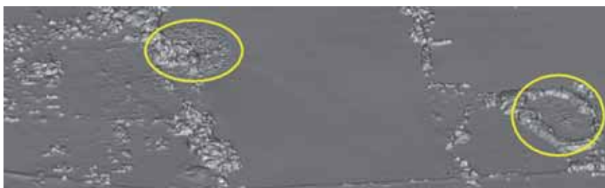
Obr. 8 Tieňovaný DMP zalietaného územia s vyznačenými chybné modelovanými vodnými plochami.
