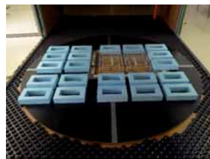
Obr. 9 Optimalizácia urbanistických štruktúr z hľadiska pôsobenia vetra, experimentálne rozmiestnenie modelov (autor: Ing. arch. Martin Hépal)
