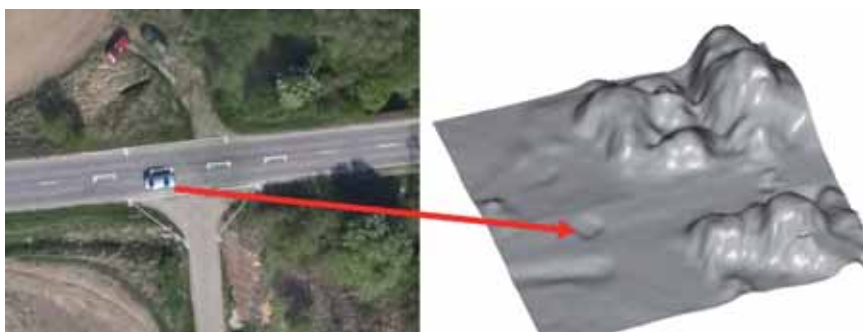
Obr. 6 Asfaltová cesta (vľavo ortofotomózika, vpravo DMP), dôsledok pohybujuceho sa vozidla
