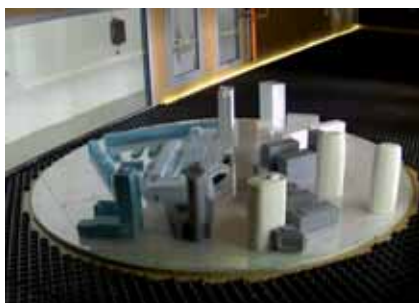
Obr. 14 Pohľad na testovanú konfiguráciu rôznych typov objektov na otočnom stole v BLWT STU Bratislava realizovanú v turbulentnom prúdení vetra
