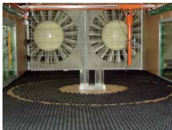
Obr. 11 Analýza Venturiho efektu pôdorysne trojuholníkových výškových budov: a) experimentálne meranie, b) príklad geometricky podobných objektov v projekte Panorama City v Bratislave (autorka: Ing. Dagmara Čehelová, PhD.)
