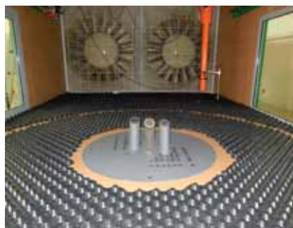
Obr. 7 Riešenie interferenčných javov v aerodynamike pôdorysne eliptických výškových budov: a) experimentálne meranie, b) príklad geometricky podobných objektov v projekte bytového komplexu Tri veže v Bratislave (autor: Ing. Michal Franek, PhD.)
