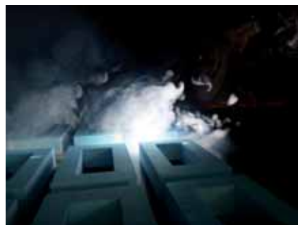
Obr. 10 Optimalizácia urbanistických štruktúr z hľadiska pôsobenia vetra, vizualizácia vzduchového prúdu: a) pomocou dymu, b) héliovými bublinami (autor: Ing. arch. Martin Hépal)
