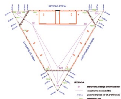
Obr. 10 Konfigurácia mikrosiete a pozorovaných bodov na 33. NP
