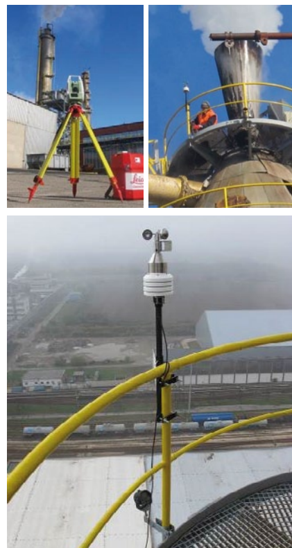
Obr. 5 UMS Leica TS30 a odrazový hranol vo vrchole desorbéra
