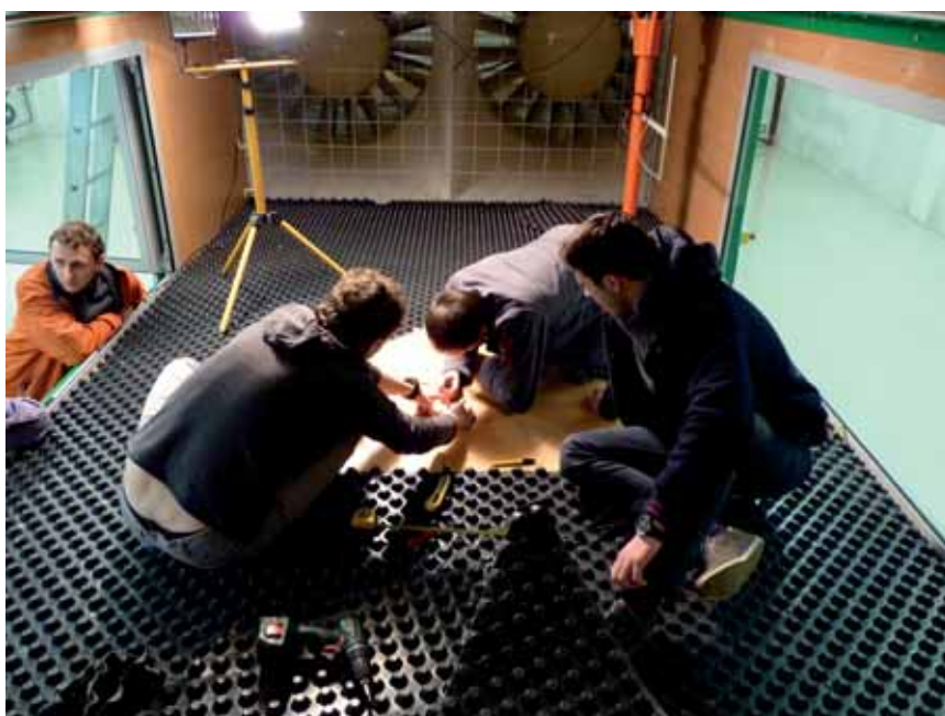
Príprava na meranie externých tlakových súčiniteľov na kocke v nízkorýchlostnom aerodynamickom tuneli
