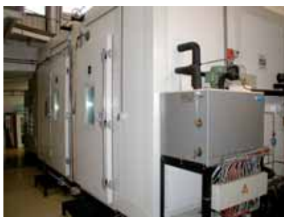
Zariadenie veľkej klíma komory na meranie tepelnotechnických vlastností okien, dvier, fragmentov stien a obvodových plášťov
