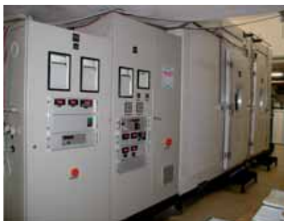
Pohľad na zariadenie veľkej klíma komory na meranie tepelnotechnických vlastností s detailom ovládacieho panela
