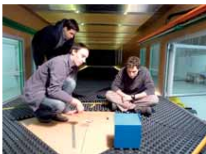
Príprava na meranie externých tlakových súčiniteľov na kocke v nízkorýchlostnom aerodynamickom tuneli
