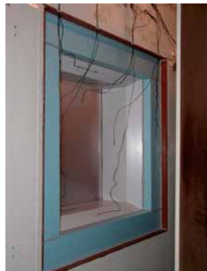
Pohľad na vzorku osadenú v maskovacom paneli veľkej klíma komory pri meraní jej tepelnotechnických vlastností
