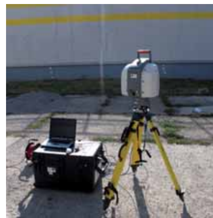
Obr. 3 Terestrický laserový skener Leica ScanStation 2 na stanovisku S1
