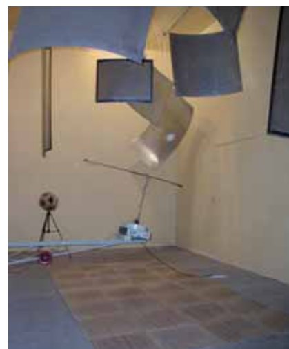
Meranie pohltivosti materiálu uloženého na podlahe dozvukovej komory v Centrálnom laboratóriu na Trnávke
