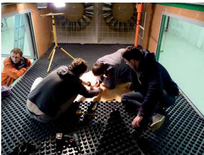
Príprava na meranie externých tlakových súčiniteľov na kocke v nízkorýchlostnom aerodynamickom tuneli
