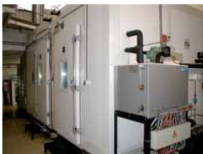
Zariadenie veľkej klíma komory na meranie tepelnotechnických vlastností okien, dverí, fragmentov stien a obvodových plášťov
