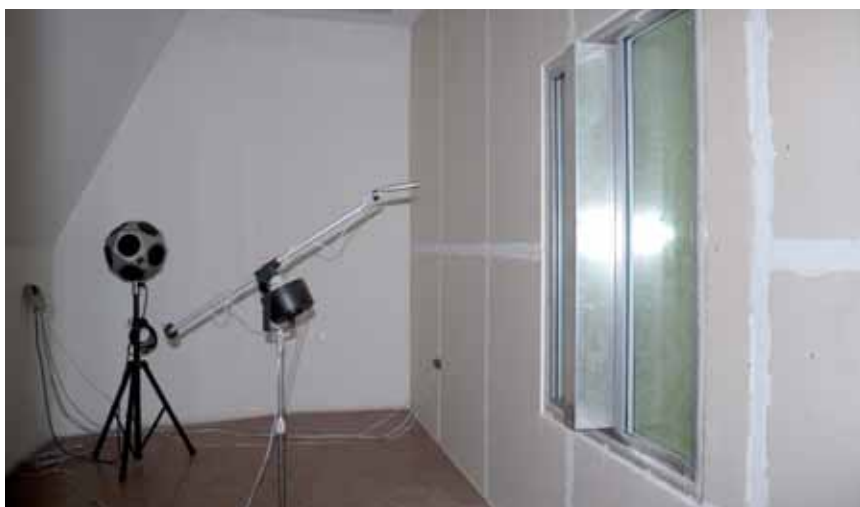
Vysielacia miestnosť s všesmerovou reproduktorovou sústavou, mikrofónom na otočnom ramene a meraným oknom s vetracou mriežkou pri meraní jeho akustických vlastností
