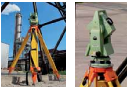
Obr. 2 Automatizovaná meracia stanica Leica TCRA 1101
