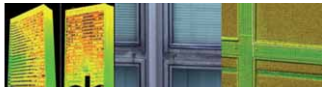
obr. 2 - mračno bodov obvodového plášťa výškovej budovy (vľavo), detail okenného rámu (v strede) a poloha pozorovaného bodu v priesečníku hrán (vpravo)
