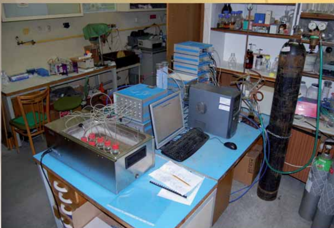
Prístroj Micro-Oxymax na meranie metabolických plynov a na záznam produkcie vodíka anaeróbnymi hubami
