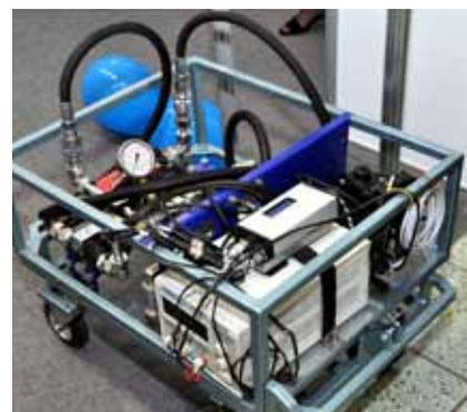
Elektro-mechanické zariadenie tímu vývojárov z Technickej fakulty, určené na testovanie hydraulického okruhu pracovnej hydrauliky
