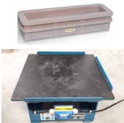
Forma na výrobu polymérbetónu a vibračný stôl Lievers LTT40/40
