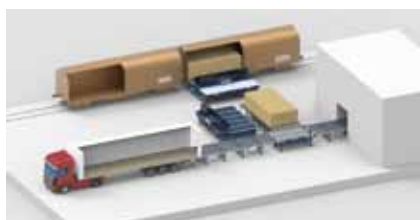
Obr.1 Automatizovaný systém nakladania a vykladania tovaru (koncept)[1].
