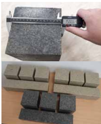
Výbraný konštrukčný materiál na báze polymérbetónových zmesí
