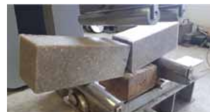
Štvorbodová skúška ohybom
