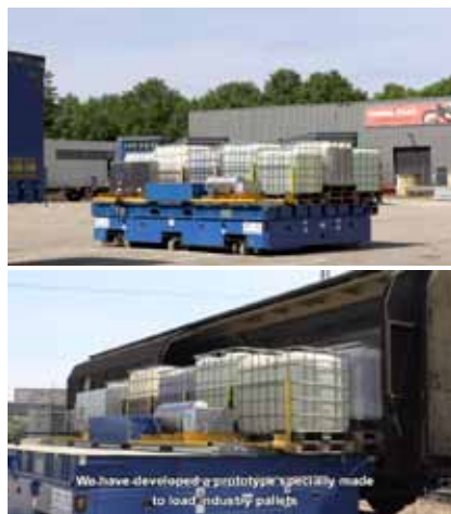
Obr.2 Automatizovaný systém nakladania a vykladania tovaru (skutočný stav)[1].
