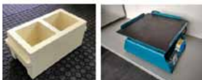
Forma na výrobu polymérbetónu (vľavo) a vibračný stôl Lievers LTT40/40 (vpravo)
