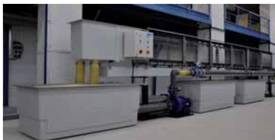
Obr. 1 Viacúčelový modulárny prietokový sklopný žľab v hydrotechnických laboratóriách SvF STU
