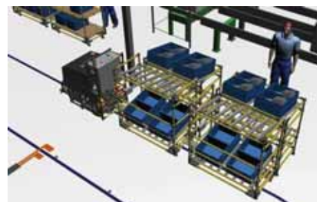
Aplikácia gravitačného presýpania v automatickom logistickom toku
