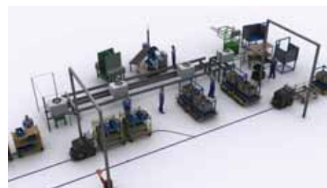
Aplikácia automatického prekladania na otočie a gravitačného presýpania do regálov
