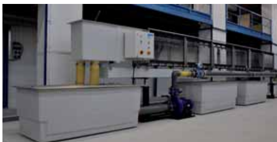
Obr. 1 Viacúčelový modulárny prietokový žlab v hydrotechnických laboratóriách SvF STU
