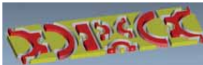
Využitie CAM systému pre simulovanie procesu, vytvorenie CNC programu a maximálne efektívne využitie materiálu.
