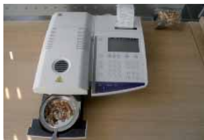
Obr. 4 Laboratórium obnoviteľných zdrojov Katedry procesnej techniky (Riadiace pracovisko a laboratórium, Halogénový žiarič HR83, Kalorimeter 6200)
