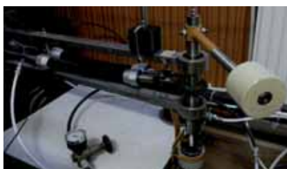
Obr. 3 funkčný vzor aktuátora na báze pneumatických umelých svalov (FESTO MAS-20)
