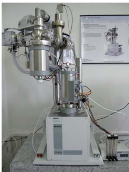
Obr. 5 Simultánný termoanalyzátor s hmotnostným spektrometrom s rozsahom teplôt od 20 do 2000°C
