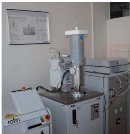
Obr. 7 Laserový flashový analyzátor na určenie teplotnej difúzivity v intervale teplôt s rozsahom od 20 do 2000°C
