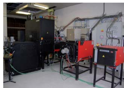
Obr. 13 Multifunkčná laboratórna pec LAC na nitridáciu, cementáciu a nitro-cementáciu
