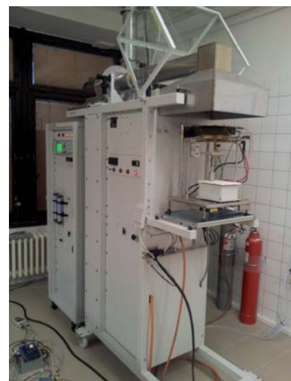
Obr. 1 Kónický kalorimeter pre tepelný tok 0 – 100 kW.m -2
