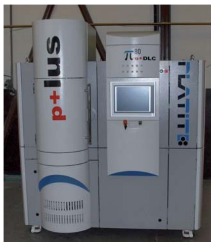
Obr. 12 Povlakovacie zariadenie Platit PI 80 na vytváranie povlakov TiN, AlTiN, CrN, AlCrN, atď.
