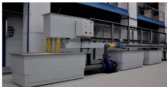
Obr. 2 Viacúčelový modulárny prietokový sklopný žľab na SvF STU
