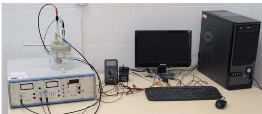
Obr. 8 Zariadenie na potenciostatické skúšky PGU 10V
