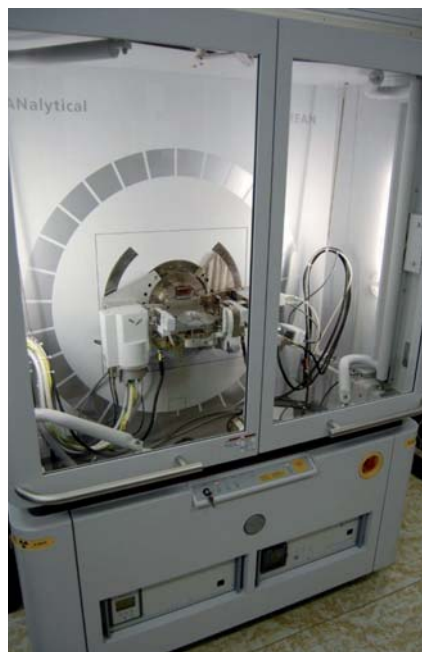
Obr. 11 Multifunkčný rtg difraktometer Panalytical EMPYREAN na analýzy v teplotnom intervale od 20 až do 1100°C
