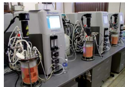
Obr. 3 Bioreaktorová jednotka na enzýmové a mikrobiálne optimalizácie na FCHPT STU
